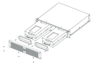
Рис. 5.1. Визуализация порядка извлечения кассеты из корпуса модуля
