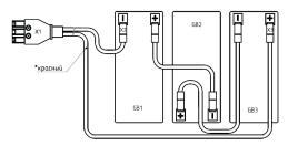
Рис. 5.7. Размещение АКБ в кассете и соединение их в линейку для БК 1500 ВА
